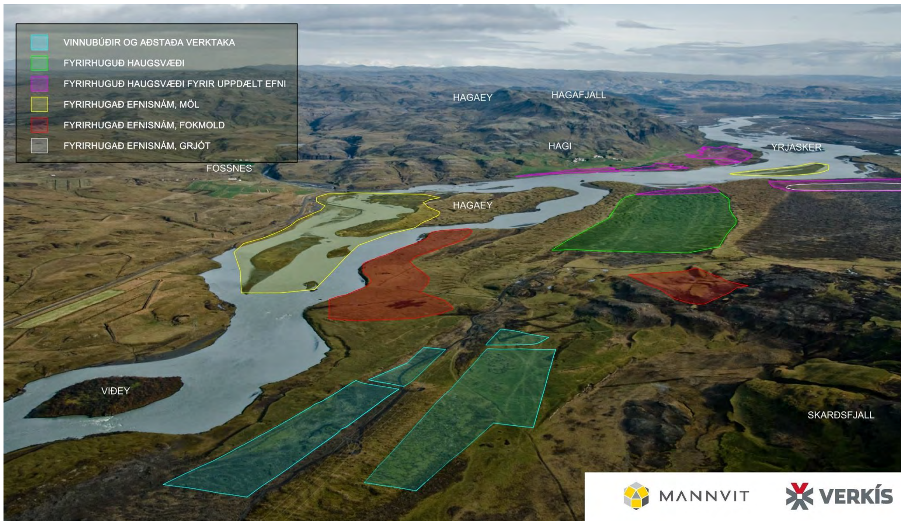
MYND 2.12 Horft í norður yfir framkvæmdasvæðið. Myndin sýnir efnistökusvæði, haugsetningu, vinnubúðir og aðstöðu verktaka.
