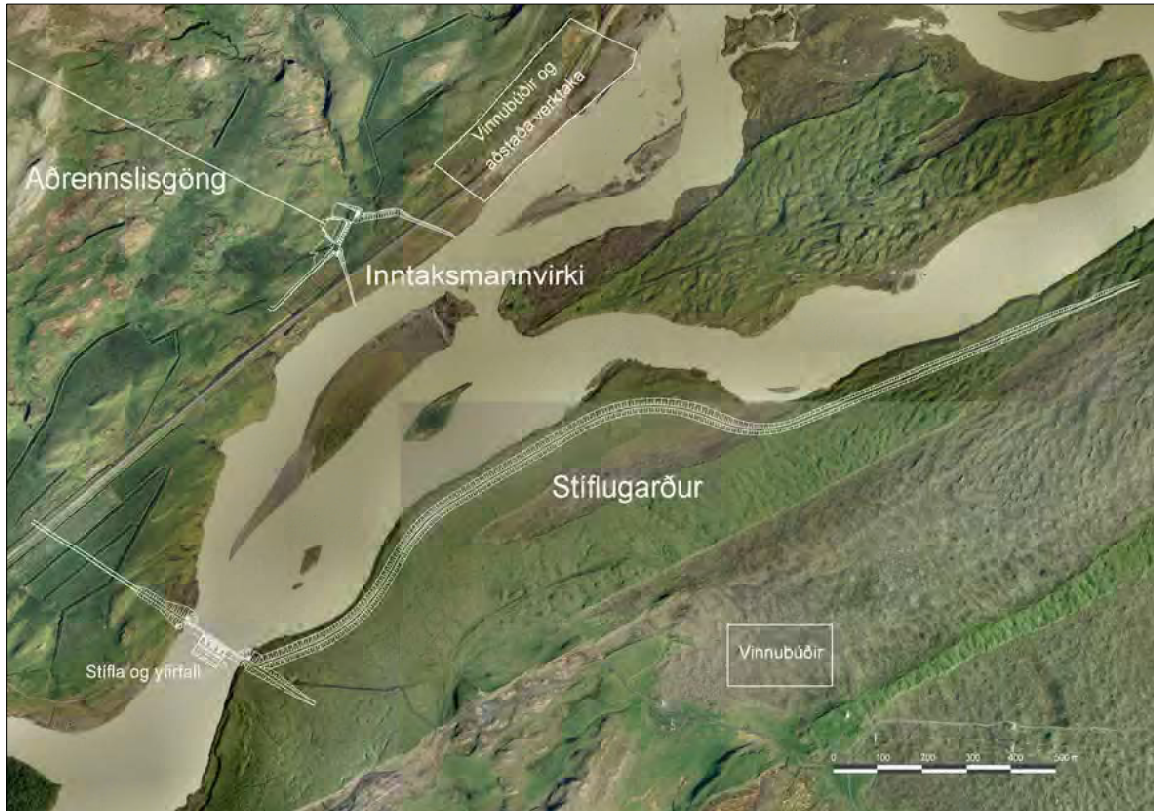
28. mynd. Stífla og neðri hluti stíflugarðs ásamt inntaksmannvirkjum Núpsvirkjunar.
