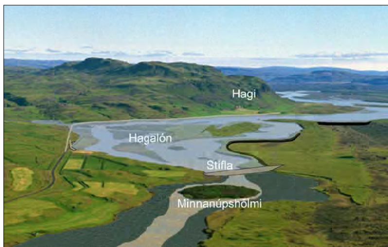
26. mynd. Myndin sýnir áætlaða legu stíflumannvirkja og inntakslóns Núpsvirkjunar.
