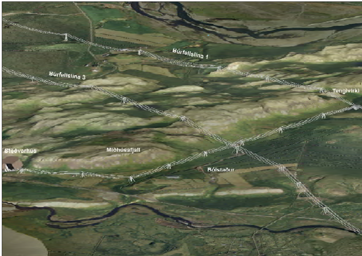
37. mynd. Núpsvirkjun tengd Búrfellslínu 1 með háspennulínu. Verði lagður jarðstrengur kemur vegslóði þar sem línan er sýnd á myndinni. Mynd Hönnun hf.
