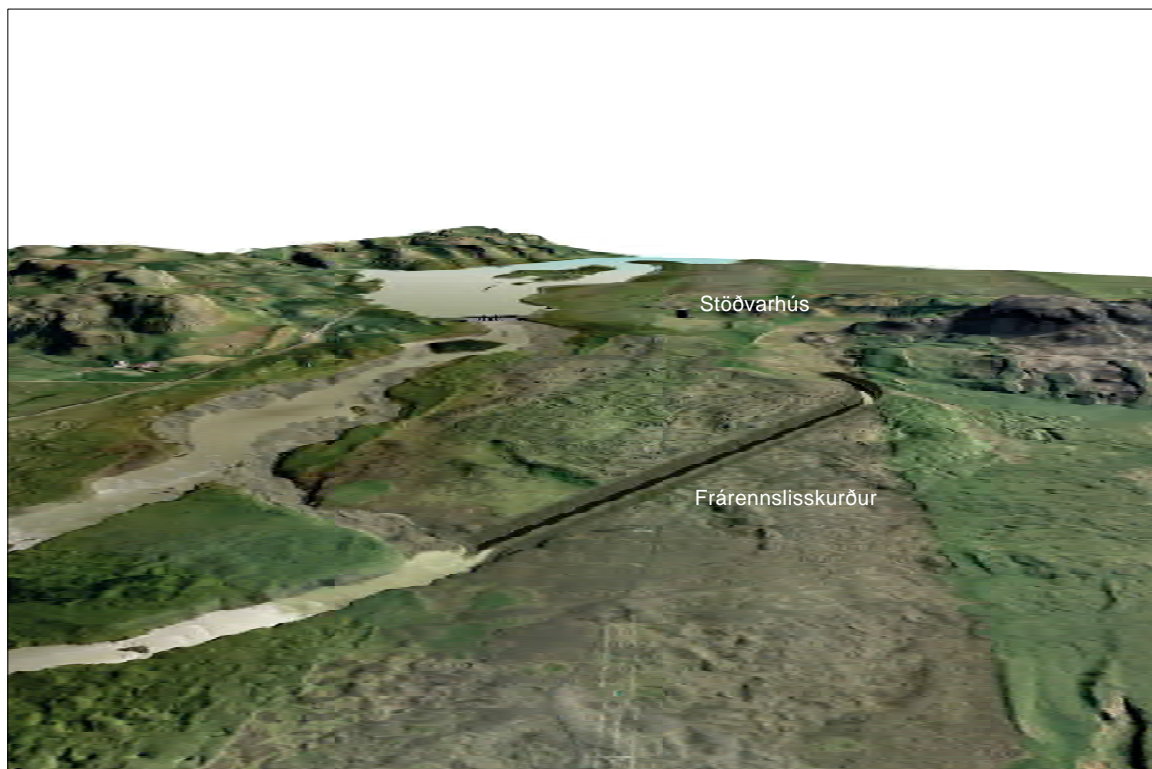
66. mynd. Tölvumyndin sýnir frárennslisskurð og önnur helstu mannvirki Hvammsvirkjunar. Efri myndin sýnir svæðið eins og það er nú. Ljós. Emil Þór.
